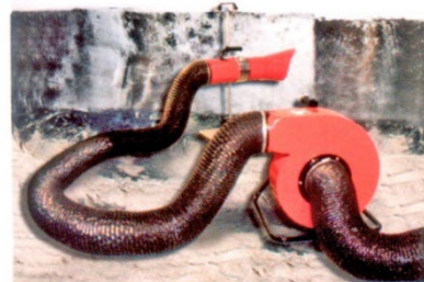
Wentylator przenośny osuszający zawilgoconą ścianę
