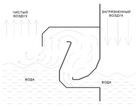
Загрязненный воздух во время протекания через направляющую опущенную в воду (переход водный) смешивается с водой, создавая вспененную смесь в виде пузырьков.
