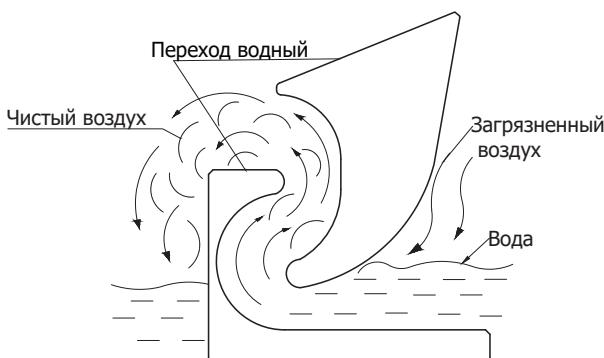
Загрязненный воздух во время протекания через направляющую опущенную в воду (переход) перемешивается с водой, создавая насыщенную воздухом смесь воды и пыли.
