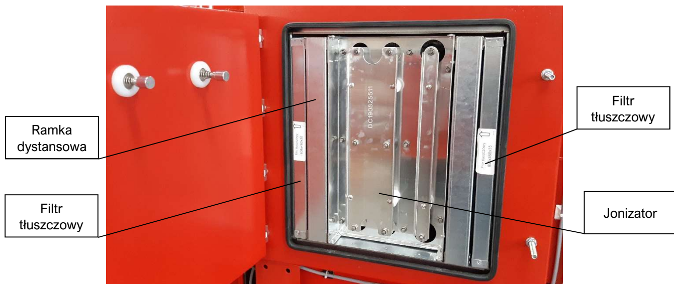
Fotografia 2 Wnętrze komory filtracyjnej
