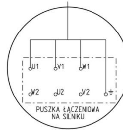
Rys. 3 Schemat połączeń elektrycznych wentylatorów typu WPA-P-N
