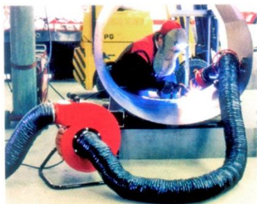
Wentylator przenośny współpracujący ze ssawką magnetyczną podczas spawania
