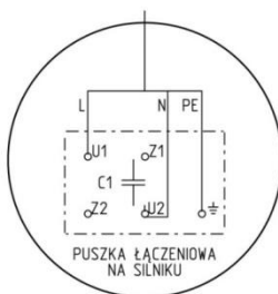
Rys. 3 Schemat połączeń elektrycznych wentylatorów typu WPA-P-N
