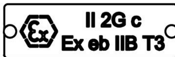
Rys. 5 Tabliczka znamionowa oraz tabliczka klasyfikacji przeciwwybuchowej
