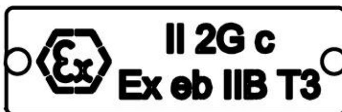
Rys. 4 Tabliczka znamionowa oraz tabliczka klasyfikacji przeciwwybuchowej
