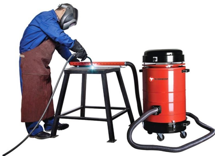
Fot. 2 Przykład zastosowania urządzenia przy spawaniu wzdłużnym
