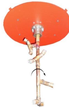
Fot. 3 System automatycznego oczyszczania filtra
