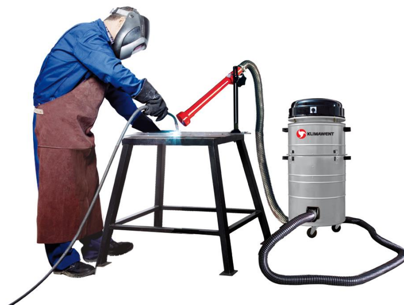
Fot. 3 Przykład zastosowania urządzenia przy spawaniu wzdłużnym
