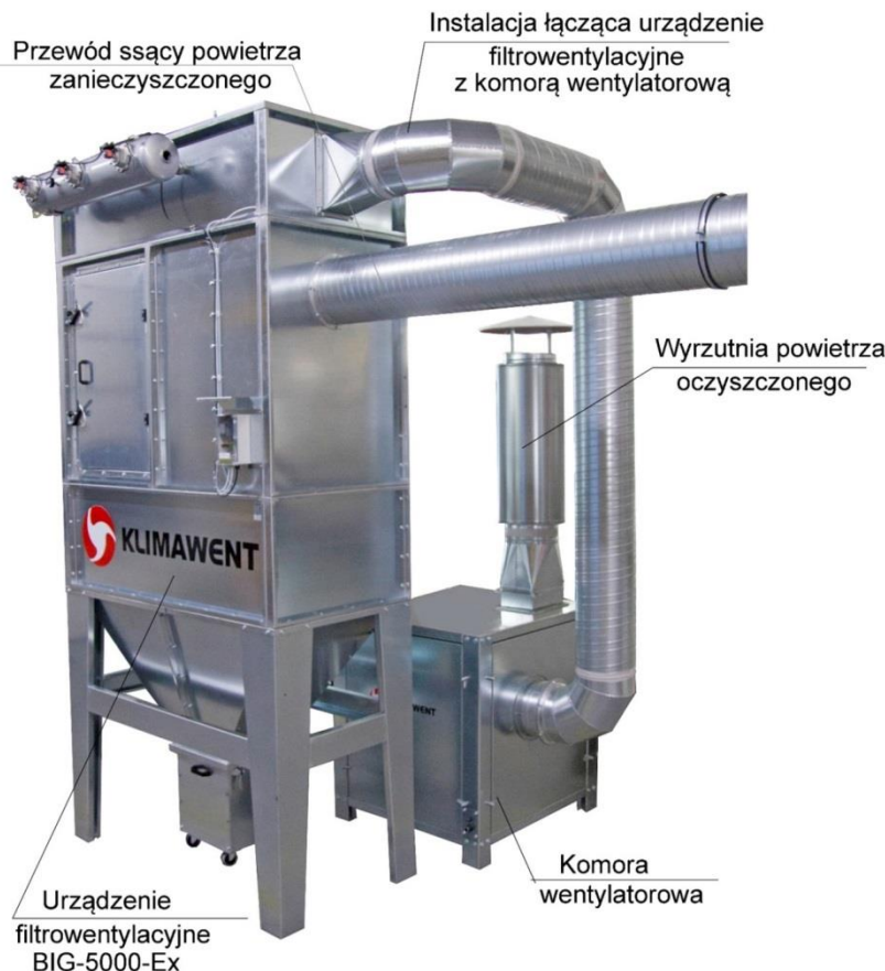
Rys.3. Urządzenie filtrowentylacyjne z komorą wentylatorową wraz z połączeniami
