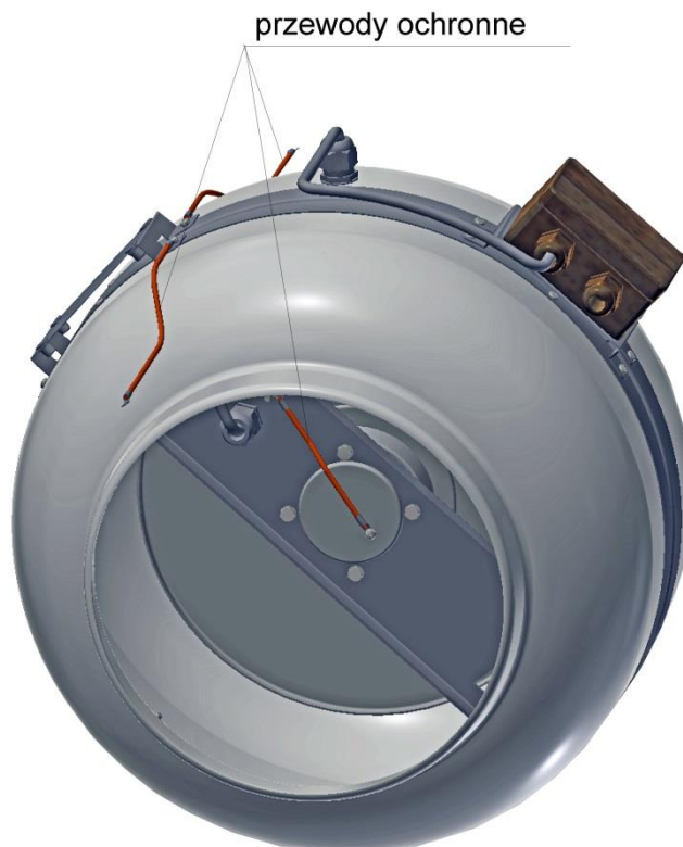
Rys. 3 Przewody ochronne wentylatora
