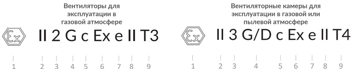
1. Обозначение взрывобезопасного исполнения
