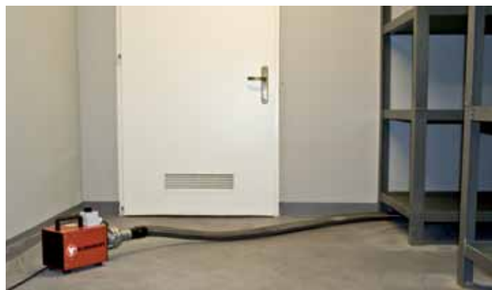
Trocknen von schwer erreichbaren Stellen mit der Anwendung eines flexiblen Schlauches
