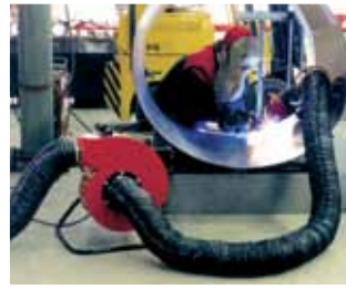
Tragbarer Ventilator mit magnetischer Saugdüse während des Schweißens
