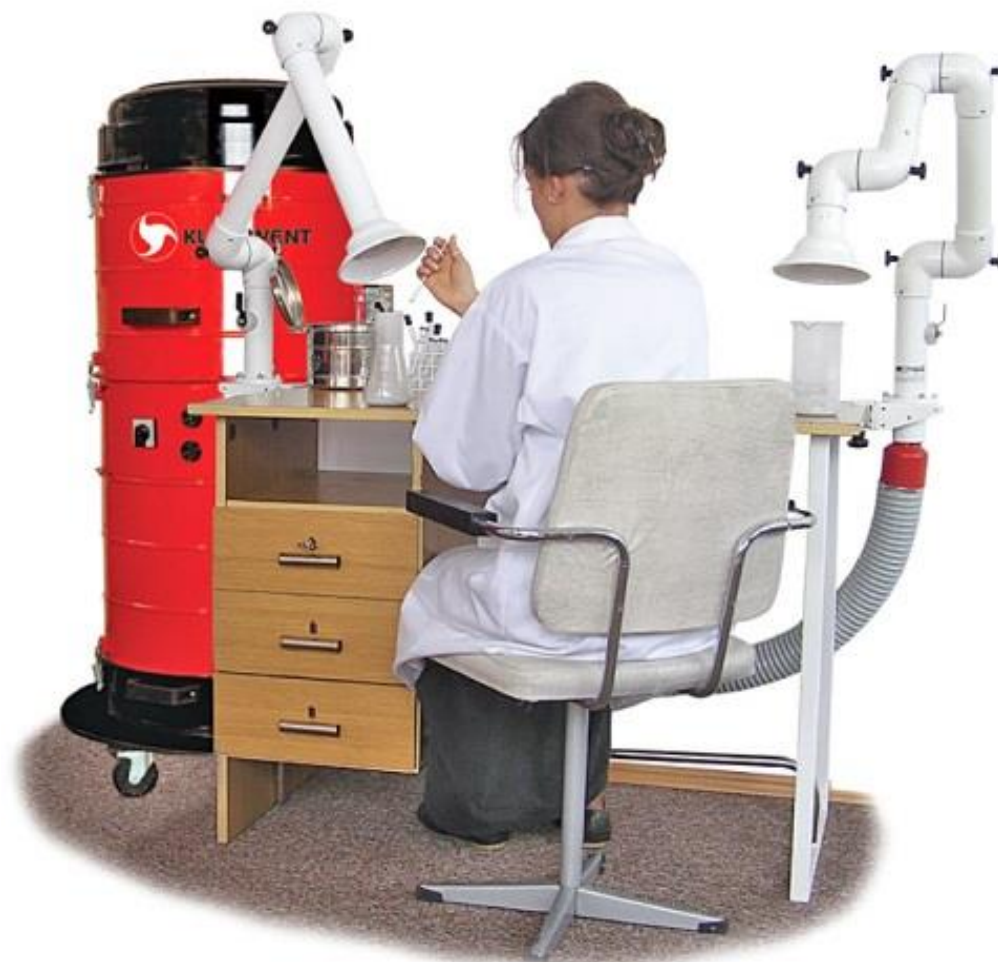
Fot. 1 Przykład zastosowania urządzenia typu TENDER VAC 200.
