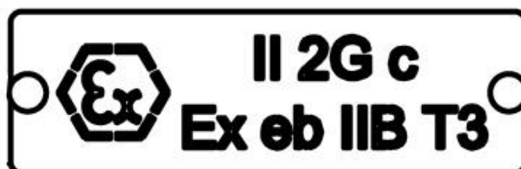
Rys. 5 Tabliczka znamionowa oraz tabliczka klasyfikacji przeciwwybuchowej
